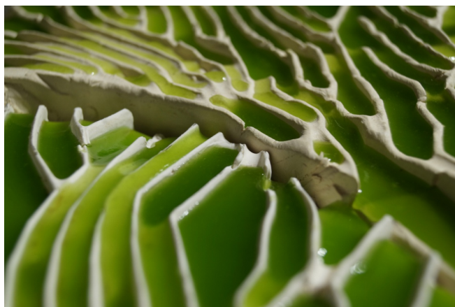
Рис. 2. Плитка, заполненная гидрогелем
